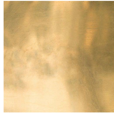
MESSING TOEPASSING: TOOG, SPATWAND EN VINNEN HERKOMST: ONBEKEND SAMENSTELLING: KOPER EN ZINK
