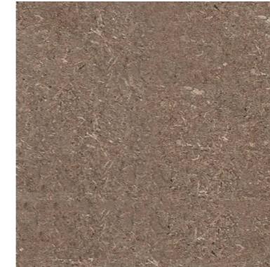
ECOBOARD TOEPASSING: CORPUSSEN, OPSTAANDE ZIJDEN BANKEN, BASIS LAMBRISERING HERKOMST: CHINA SAMENSTELLING: LANDBOUWRESTEN UIT RIJSTTEELT
